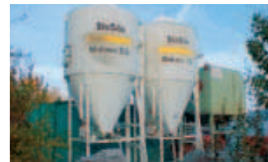
StoSilo Midimix 12.5 mit bis zu 18 Tonnen Fassungsvermögen
