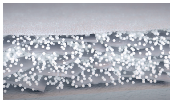
Die Rezeptur besteht aus Pigmenten, Füllstoffen und einem selbstvernetzenden Bindemittel. Nach der Trocknung liegen die plättchenförmigen Füllstoffe wie kleine Panzerschuppen übereinander und bilden so eine robuste, abwischbare Schicht.
