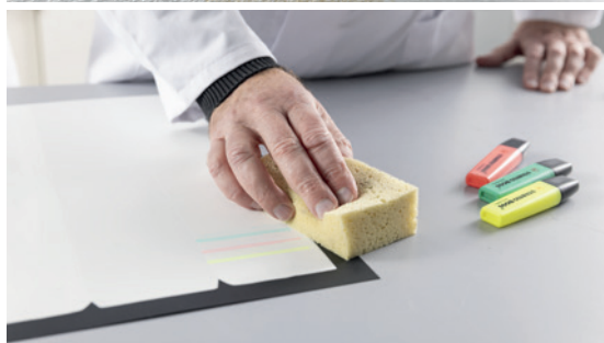
Selbst Textmarkerstreifen lassen sich problemlos entfernen. StoColor PuraClean (mitte) im Härtestest zur 2-Komponenten Lackfarbe (links) und Standard-Innenfarbe (rechts).
