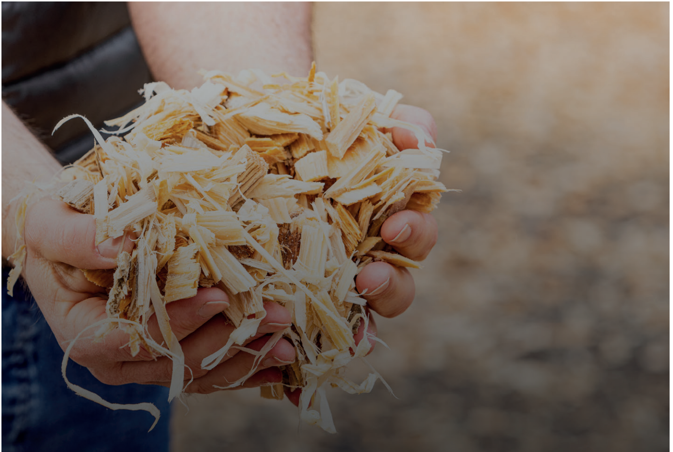
Rohstoff für den Dämmstoff Holzweichfaser: Reststoffe aus der Holzverarbeitung
