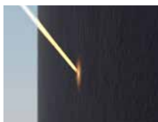
Herkömmliche Beschichtung Im nicht sichtbaren Nahinfrarotbereich werden große Teile der Sonnenenergie absorbiert, die Fassade heizt sich auf.
