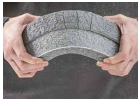
Biegestreifentest: oben - Mineralisches Putzsystem unten - Organisches, dehnfähiges StoRend Classic Unterputzsystem
