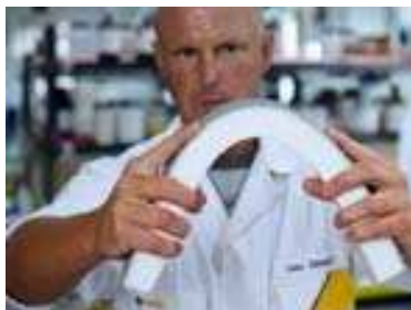
Der Biegeversuch zeigt die außerordentliche Elastizität und somit hohe Rissicherheit von StoTherm Classic.
